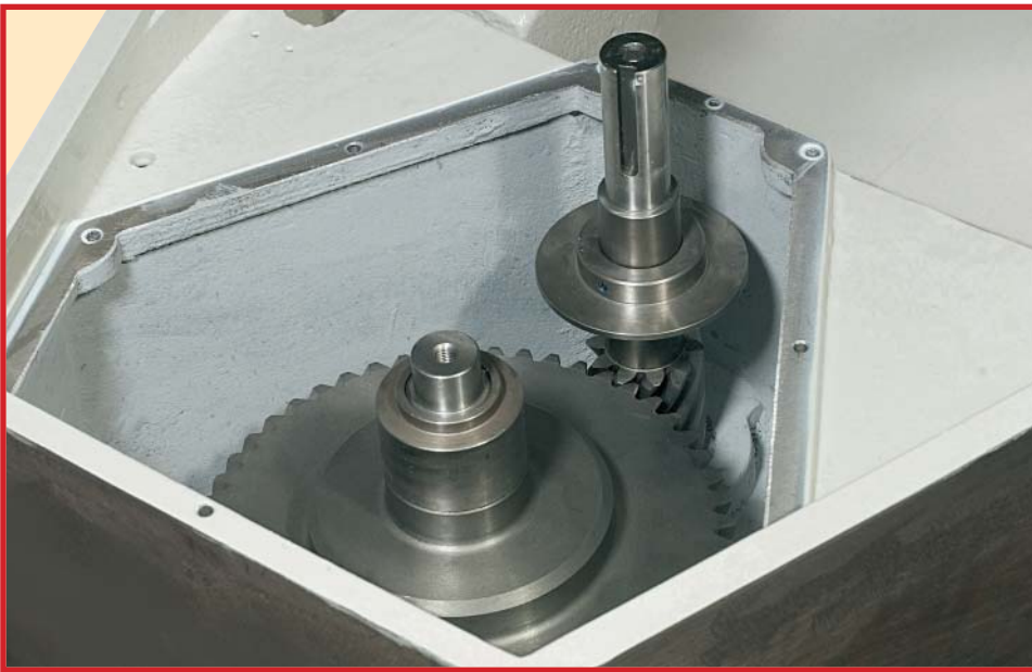
Nebenantrieb durch Schrägzahnräder im Ölbad. Transmissiòn secundaria por engranajes helicoidales rectificados en baño de aceite
