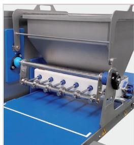
MAS con cinta transportadora adaptada para el dosificado en continuo de plancha de bizcocho.
