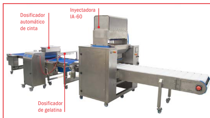
Línea modular para la inyección de croissants con gelatina y topping
